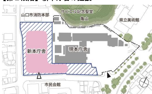
【第3段階】現本庁舎の解体
